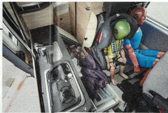
Die Unterkonstruktion der Sitzbank brach beim Crash in sich zusammen. In der Folge rutschte der Beckengurt in den Bauchraum. So kann er innere Verletzungen verursachen
